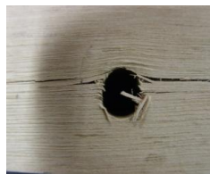
Figura 57: Ruptura por fendilhamento perpendicular às fibras do Eucalyptus saligna .
