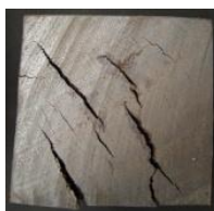
Figura 49: Rachaduras e combustão nos topos dos corpos de prova.
