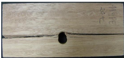
Figura 57: Ruptura por fendilhamento perpendicular às fibras do Eucalyptus saligna .
