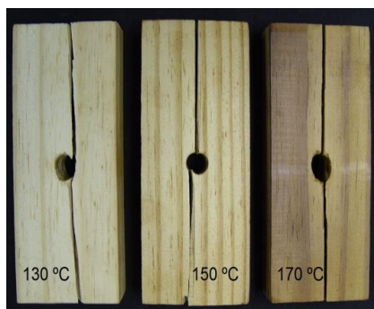
Figura 56: Ruptura por fendilhamento paralelo as fibras.
