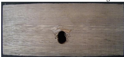
Figura 58: Ruptura por embutimento perpendicular às fibras do Eucalyptus saligna .
