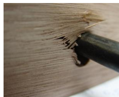
Figura 58: Ruptura por embutimento perpendicular às fibras do Eucalyptus saligna .
