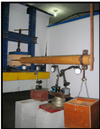
Figura 4: Montagem do ensaio de flexão
