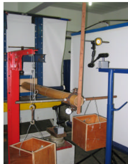
Figura 5: Montagem do ensaio de torção
