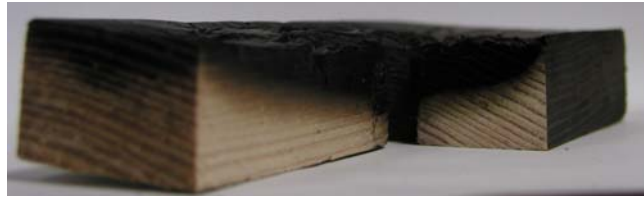
Figure 3-19: Coupe d'une éprouvette avec trou sans tige
