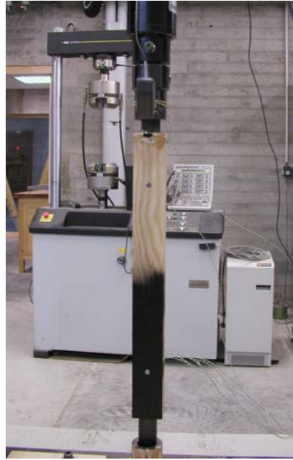
Figure 4-12: Essai de détermination de R_k
