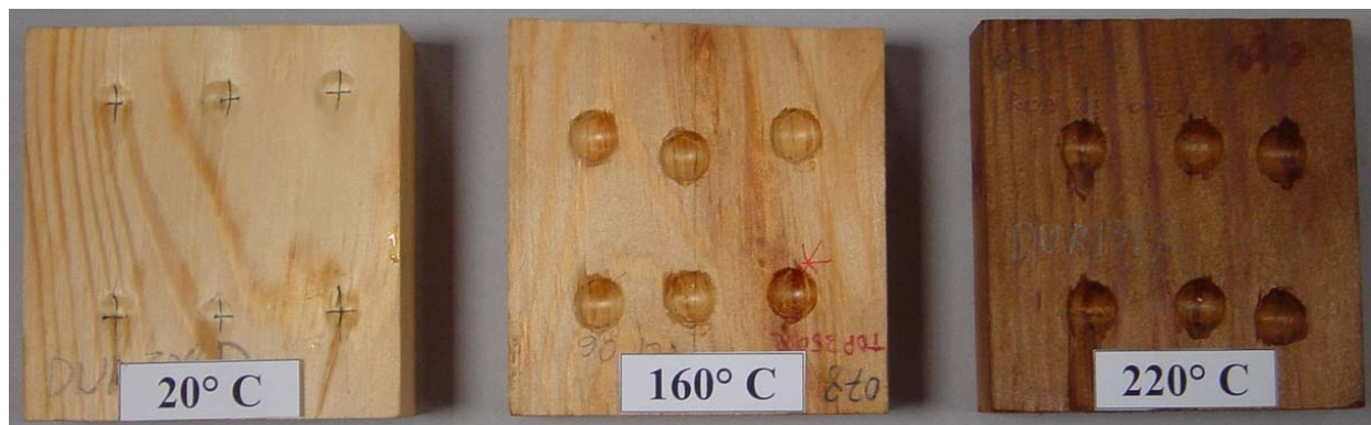
Figure 2-40: Éprouvettes après avoir été testées
