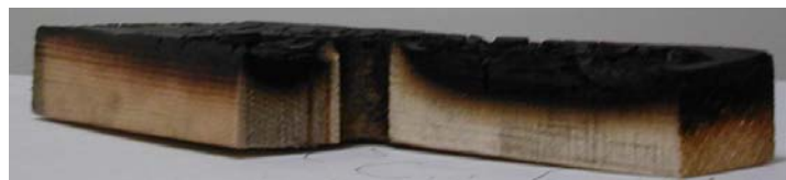
Figure 3-21: Coupe d'une éprouvette avec tige en finition naturelle
