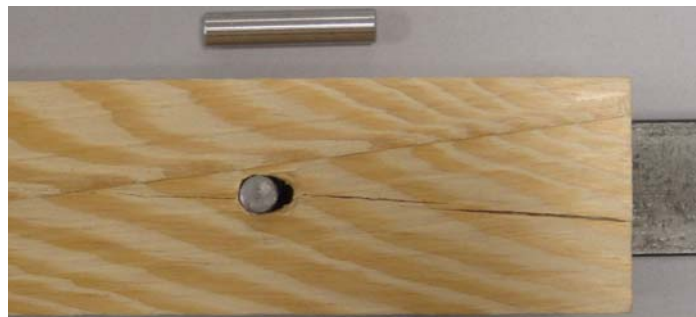
Figure 4-14: Rupture d'une éprouvette de contrôle
