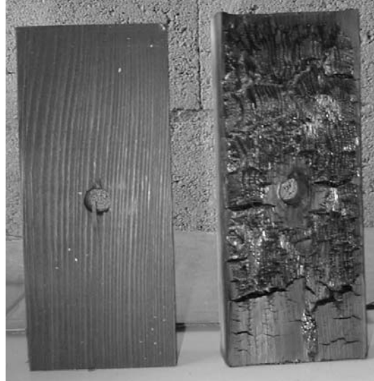
Figure 3-17: Epreuves respectivement non carbonisée et carbonisée
