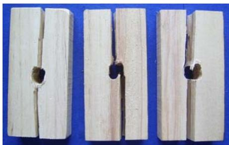
**Figura 8:** Ruptura dos corpos-de-prova por fendilhamento a 150 °C.
