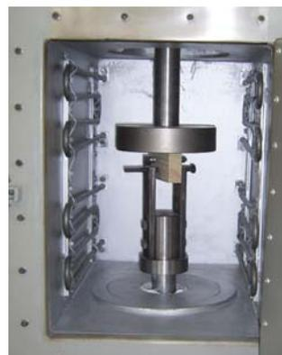
**Figura 2:** Câmara térmica para realização dos ensaios.
