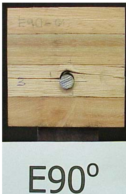
Figura 3.4.5-3 Modo de ruptura dos ensaios de embutimento com ângulo de 90^\circ
