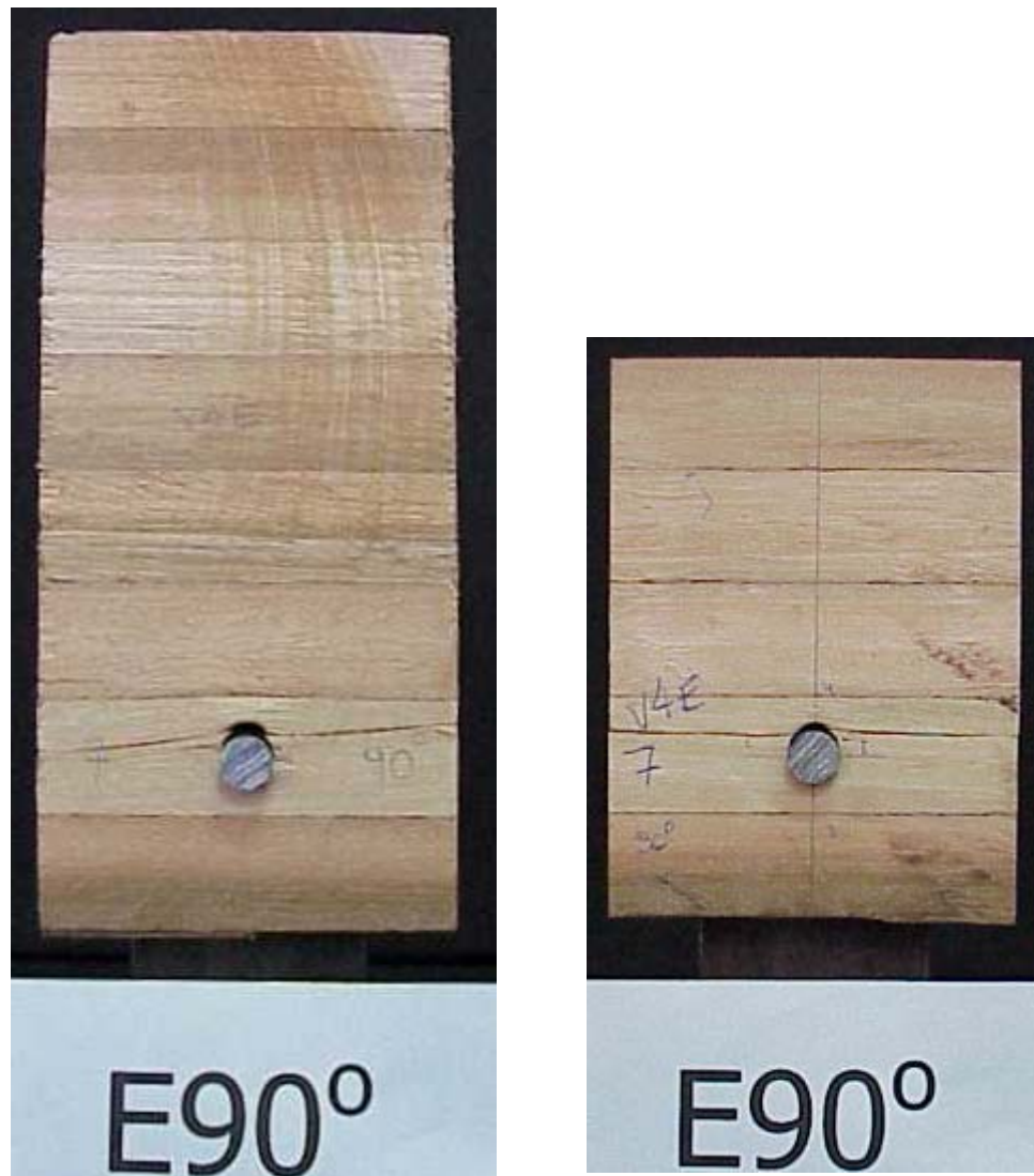
Figura 3.4.5-2 Geometria de corpos-de-prova para embutimento com ângulo de 90^\circ
