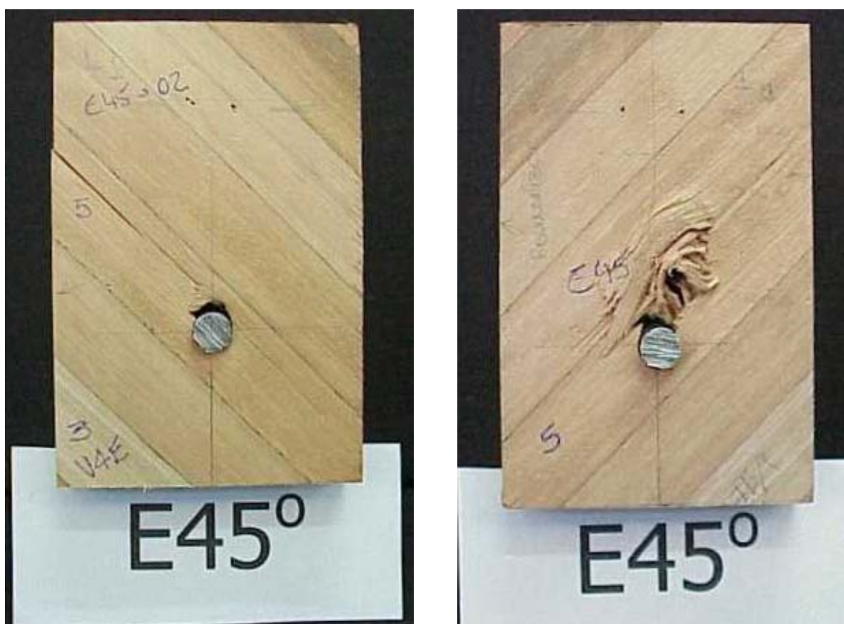
Figura 3.4.3-1 Modos de ruptura dos ensaios de embutimento com ângulo de 45°
