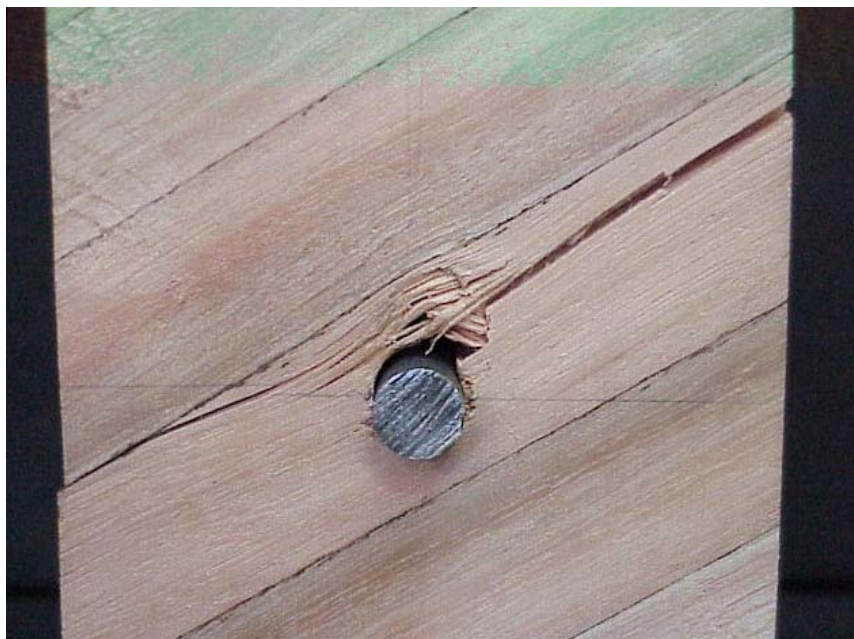
Figura 3.4.4-2 Detalhe da ruptura dos ensaios de embutimento com ângulo de 60°
