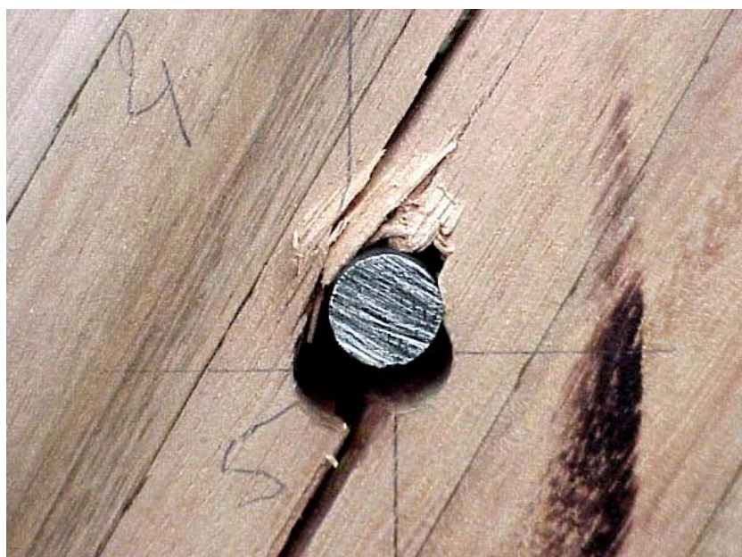
Figura 3.4.2-4 Detalhe da ruptura do corpo-de-prova E30-06
