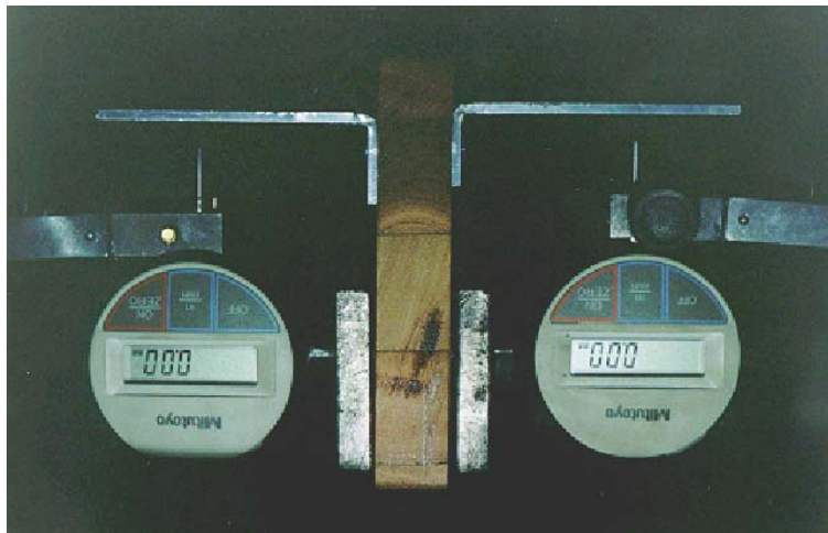
Figura 3.2.3-1 Disposição dos corpos-de-prova de embutimento no equipamento de ensaio
