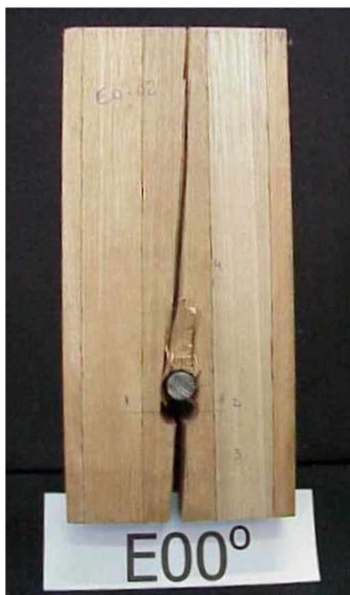
Figura 3.4.1-1 Modo de ruptura dos ensaios de embutimento com ângulo de 0°
