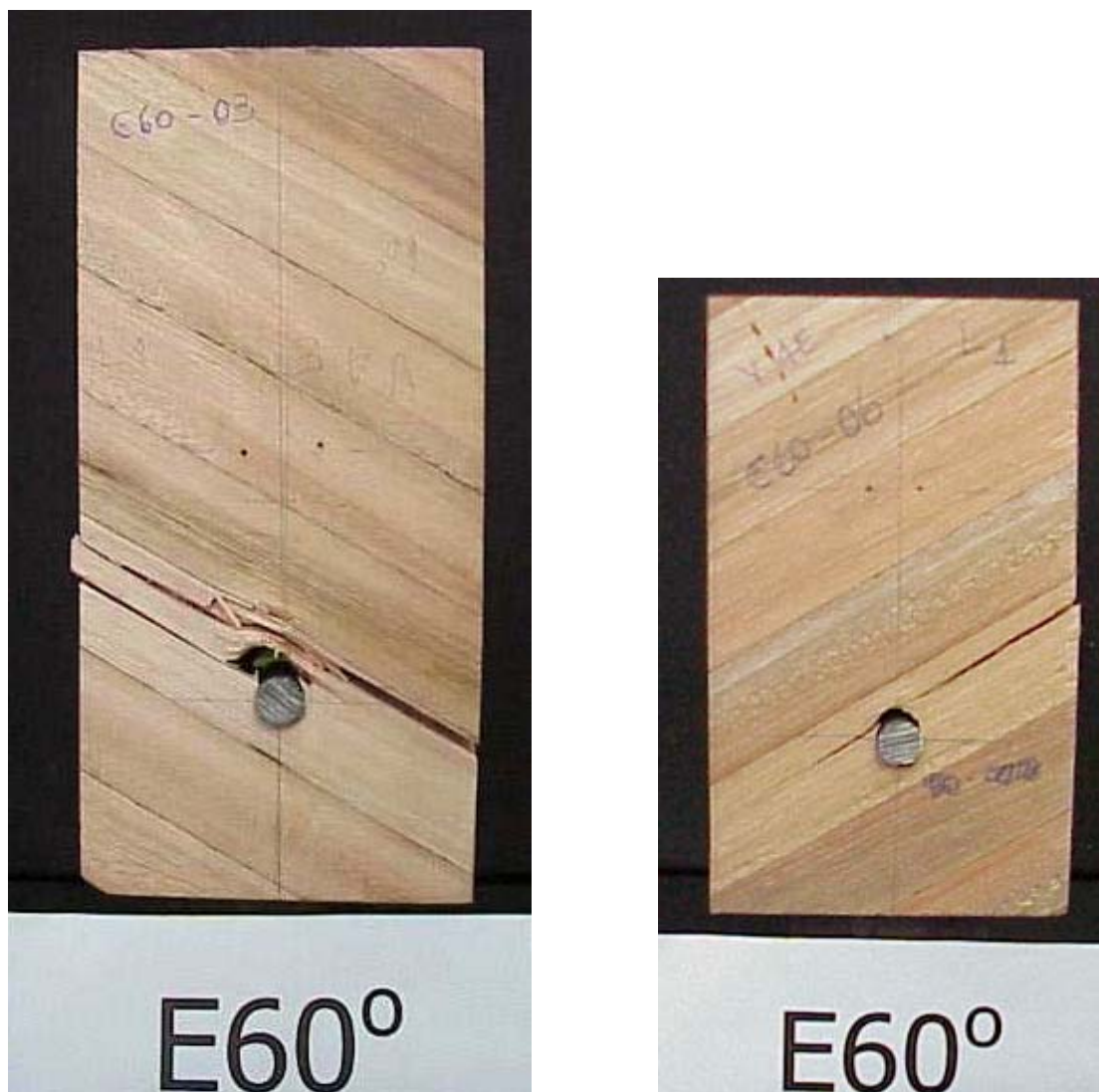
Figura 3.4.4-1 Modo de ruptura dos ensaios de embutimento com ângulo de 60°
