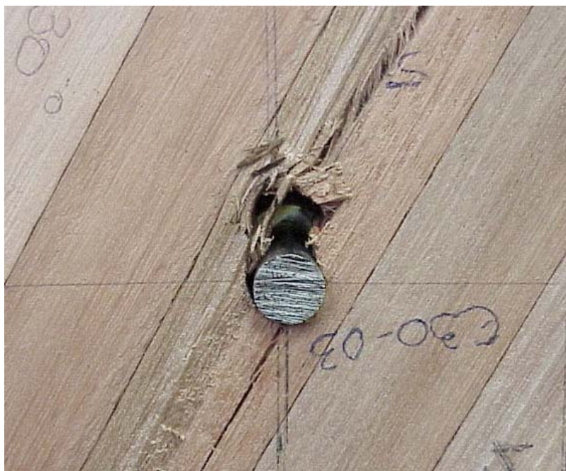
Figura 3.4.2-3 Detalhe da ruptura do corpo-de-prova E30-03
