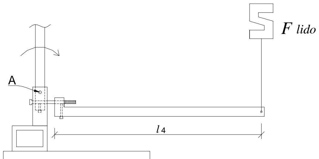
Figura 4.2.2-4 Dispositivo de ensaio de flexão em pinos metálicos sugerido pela prEN 409 (1993)
