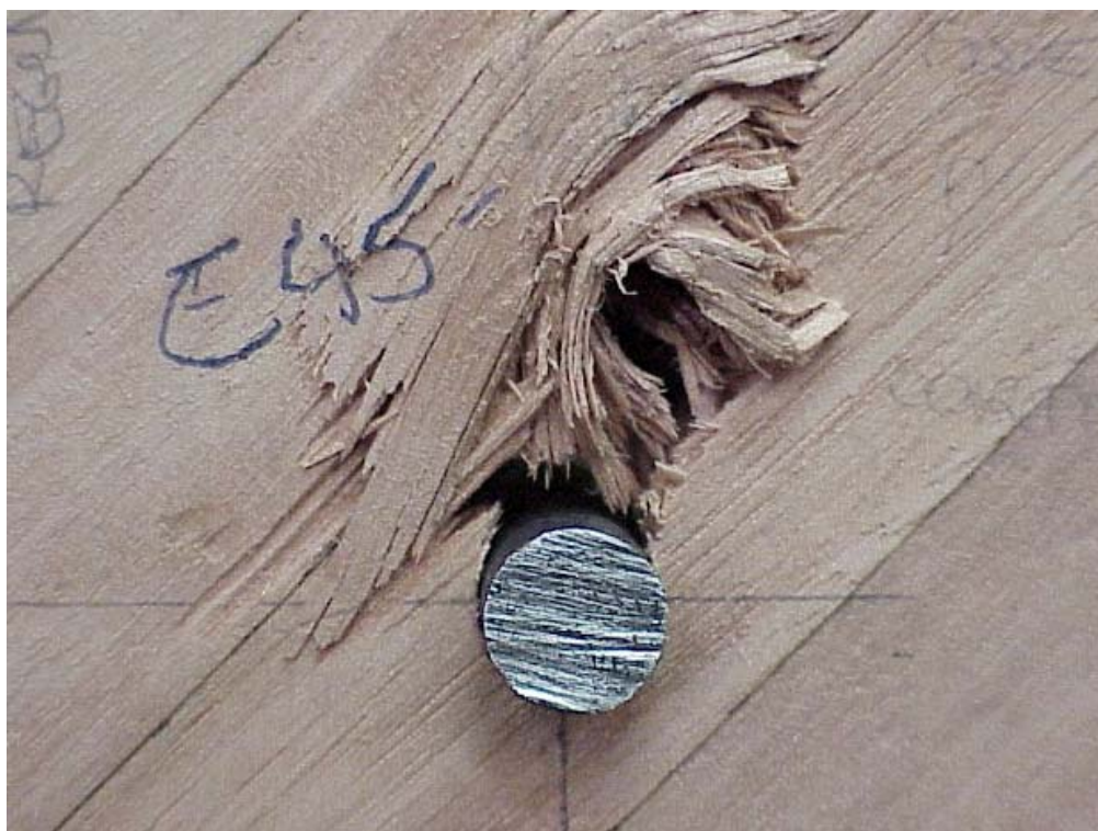
Figura 3.4.3-2 Detalhe da ruptura do corpo-de-prova E45-04
