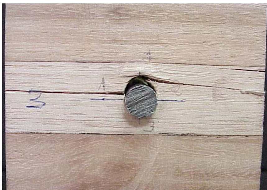
Figura 3.4.5-4 Detalhe da ruptura dos ensaios de embutimento com ângulo de 90^\circ
