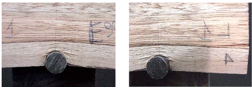
Figura 3.4.5-6 Detalhes do modo de ruptura dos ensaios de embutimento com ângulo de 90°
